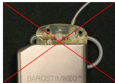
Nesprávne umiestnenie zvodu za IPG
