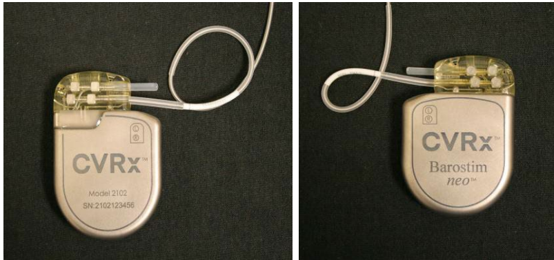
20. ábra: Az elektródtest felesleges részének helyes elrendezése
