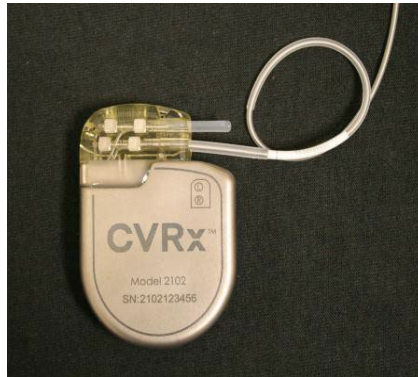
Kuva 20: Ylimääräinen johtimen runko sijoitettu oikein
