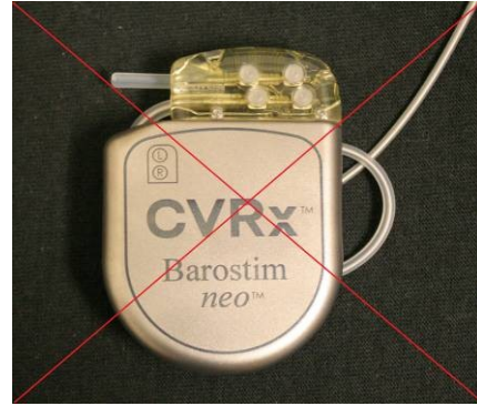
Ucun IPG arkasında yanlış yerleştirilmesi
