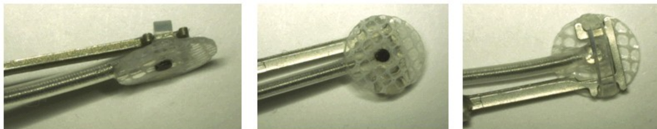
Figur 15: Spännelektroden införd i implantationsinstrument av typen "spänne"
