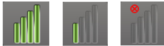
Figura 10: Indicador de calidad del enlace (excelente, deficiente, sin enlace)
