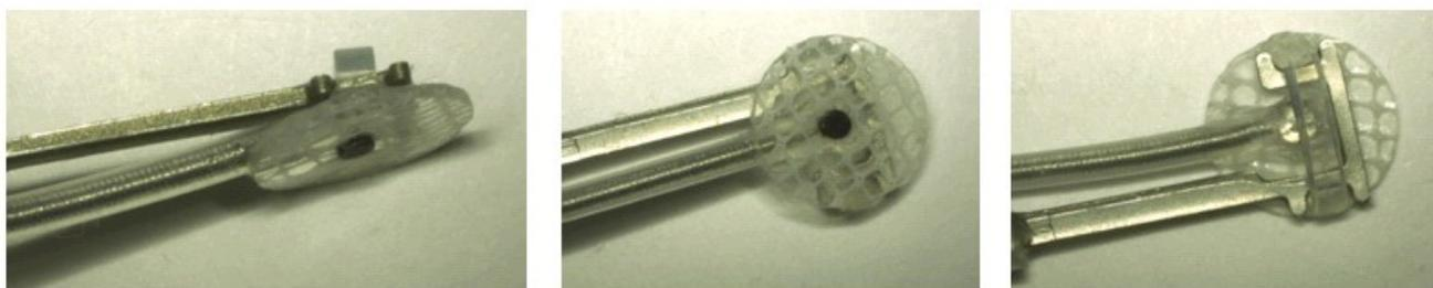
**Figura 15: Electrodo con brida engranado en la herramienta de implante con brida**
