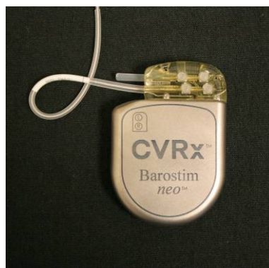
Obrázok 20: Správne umiestnenie nadbytočného tela elektródy
