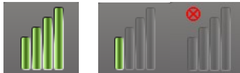
Obrázok 10: Indikátor kvality spojenia (výborné, slabé, žiadne spojenie)
