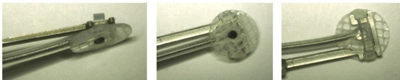
Rysunek 15: Elektroda wprowadzona do gniazda przyrządu do implantacji
