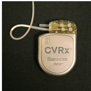
Figur 22: Riktig plassering av overflødig ledning
