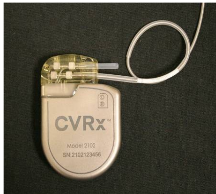
Figur 22: Riktig plassering av overflødig ledning
