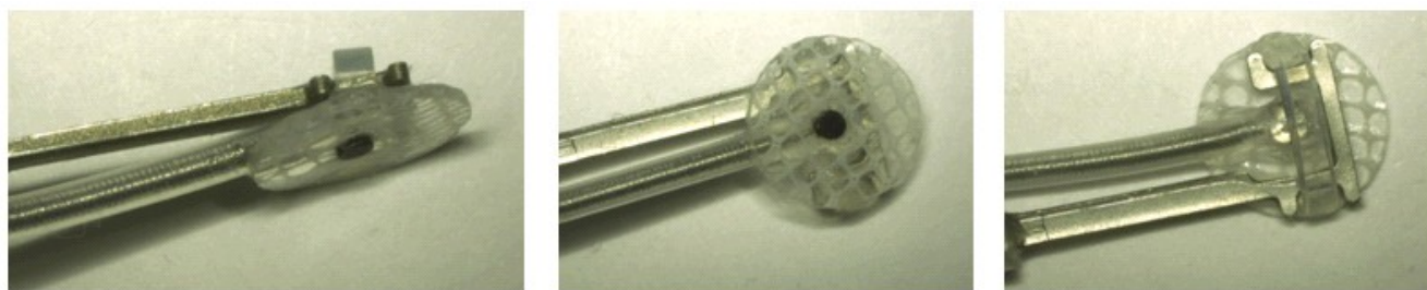
Figur 15: Bøyleledning satt på implanteringsverktøyet med bøyle
