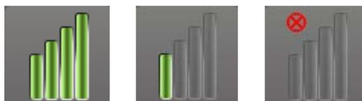
**Figura 9. Indicatore di qualità del collegamento (eccellente, scadente, assente)**
