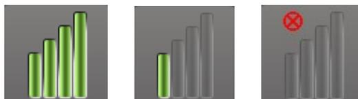
**Figura 10. Indicatore di qualità del collegamento (eccellente, scadente, assente)**
