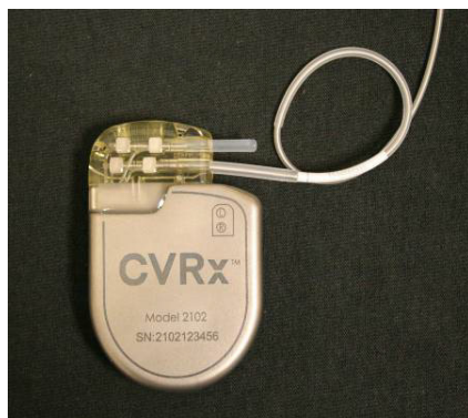
22. ábra: Az elektródatest felesleges részének helyes elrendezése
