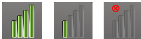
10. ábra: A Link Quality (Kapcsolat minősége) kijelző – az Excellent (Kiváló), a Poor (Gyenge) és a No Link (Nincs kapcsolat) érték
