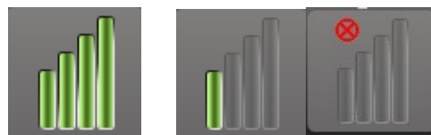
10. ábra: A Link Quality (Kapcsolat minősége) kijelző – Excellent (Kiváló), Poor (Gyenge) és No Link (Nincs kapcsolat) értékek
