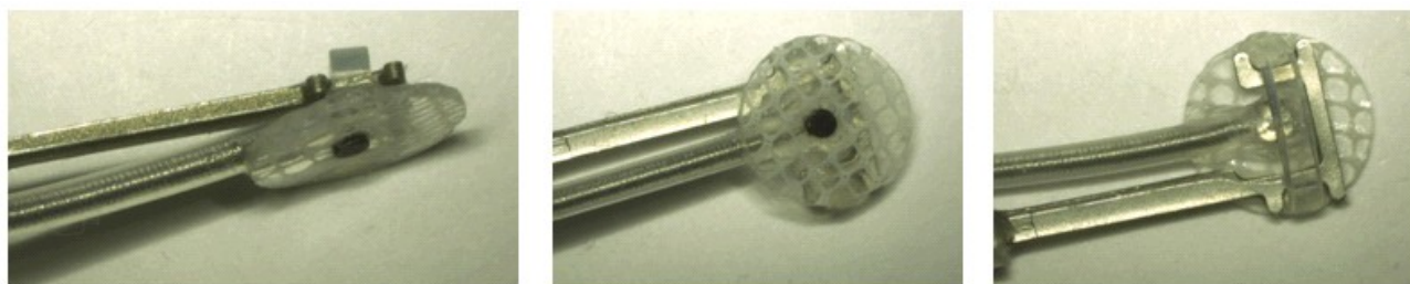
15. ábra: Kapocselektroda a kapcsos implantálóeszközben rögzítve
