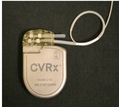
Σχήμα 22: Σωστή τοποθέτηση της περίσσειας σώματος καλωδίου
