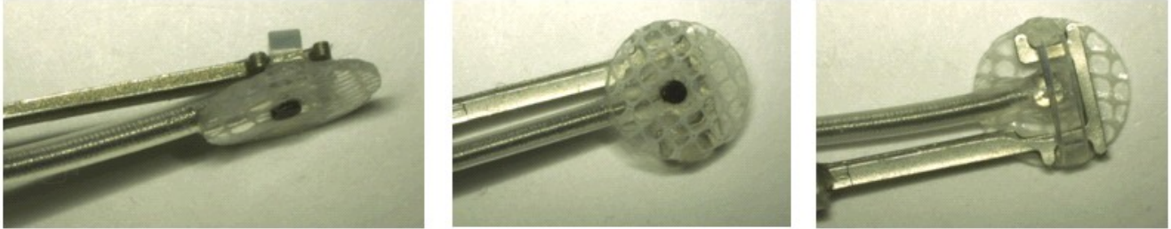
Σχήμα 15: Καλώδιο πόρπης συνδεδεμένο στο εργαλείο εμφύτευσης με πόρπη
