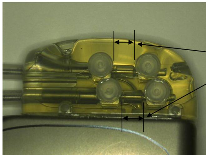
Nur eine Anschlussdichtung befindet sich im Sichtbereich (sowohl oberer als auch unterer Kopfanschluss).
