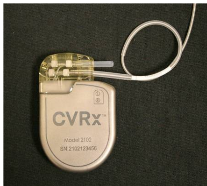
Figure 22 : Placement correct de l'excédent du corps de la sonde
