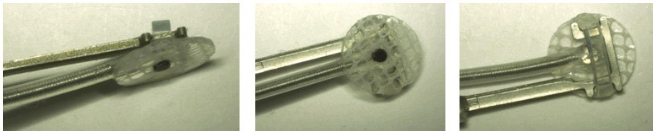
Figure 15 : Sonde boucle insérée dans l'outil d'implantation à boucle
