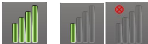
Figure 10 : Indicateur de qualité de liaison (excellente, médiocre, pas de liaison)
