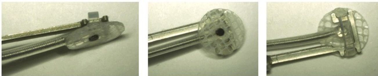
Kuva 15: Solkijohdin kiinni solkityökalussa
