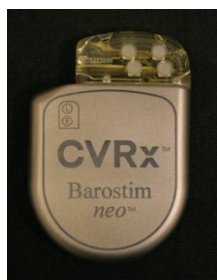
Afbeelding 2: De implanteerbare pulsgenerator
