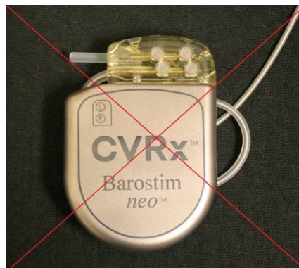
Forkert placering af elektrode bag IPG
