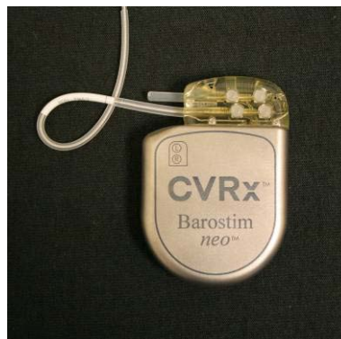
Obrázek 22: Správné umístění nadbytečné délky těla elektrody
