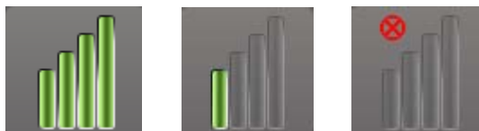
Obrázek 10: Indikátor kvality spojení (Výborné, Špatné, Není spojení)
