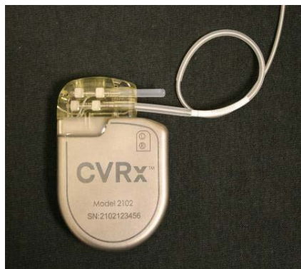
Obrázek 22: Správné umístění nadbytečné délky těla elektrody
