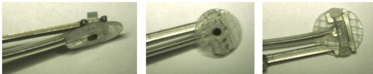
Obrázek 15: Úchytová elektroda zachycená v implantačním nástroji zakončeném úchytem
