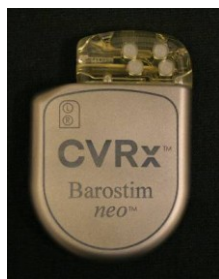
Obrázek 2: Implantovatelný pulzní generátor
