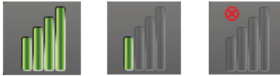
Afbeelding 6: Link Quality Indicator (uitstekend, slecht, geen link)
