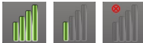
Figura 9: Indicador de calidad del enlace (excelente, deficiente, sin enlace)
