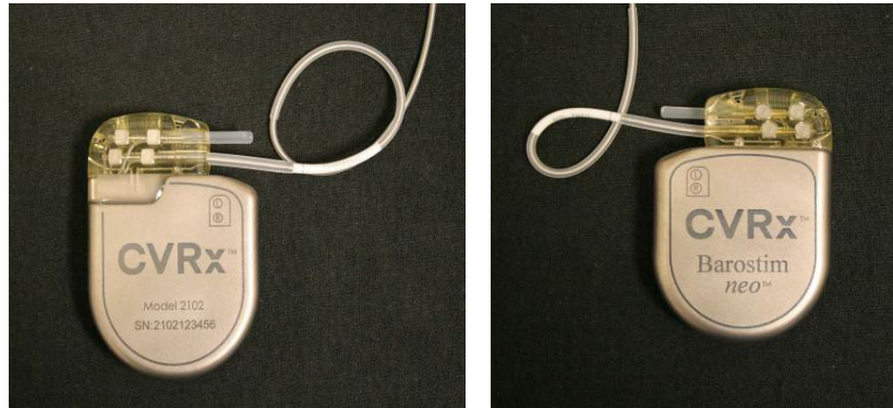
Figura 20: Colocación correcta del exceso de cuerpo del electrodo
