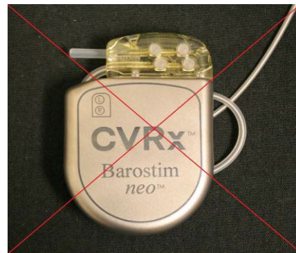
Posizionamento errato della derivazione dietro l'IPG
