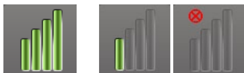
Figure 9 : indicateur de qualité de liaison (excellente, médiocre, pas de liaison)
