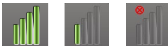
Afbeelding 6: Link Quality Indicator (uitstekend, slecht, geen link)
